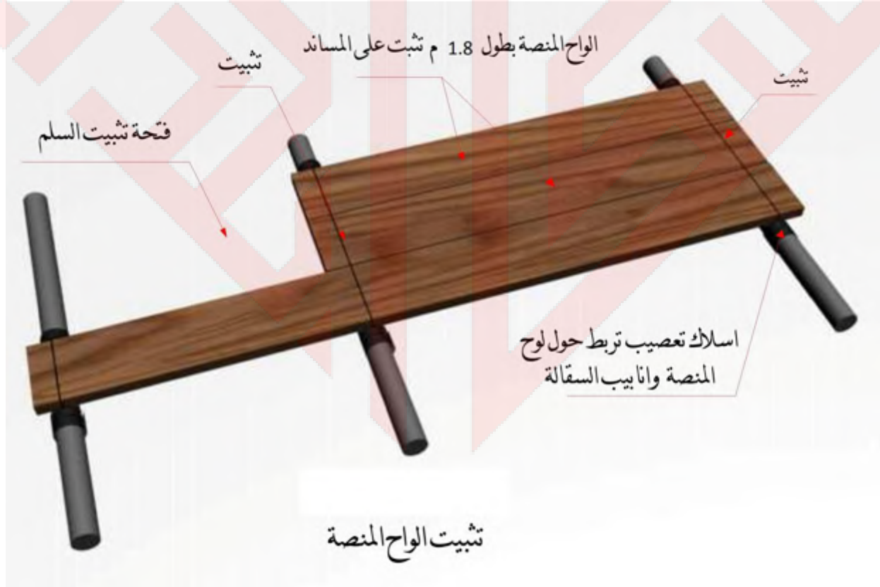
الشكل 6-1/9: تثبيت منصة العمل على هيكل السقالة
